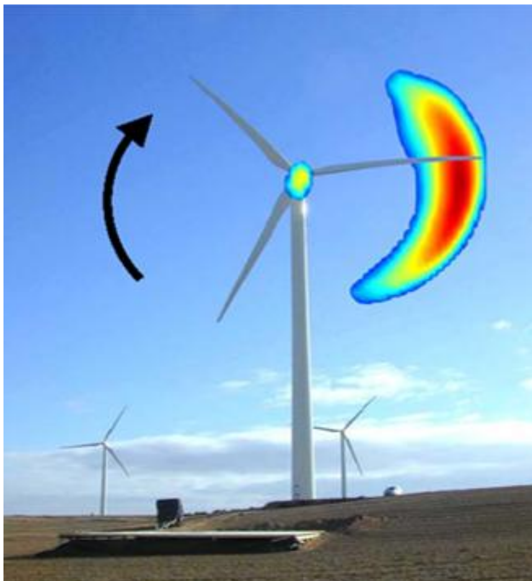
Photo 1: localisation visuelle des sources de bruit sur une éolienne
